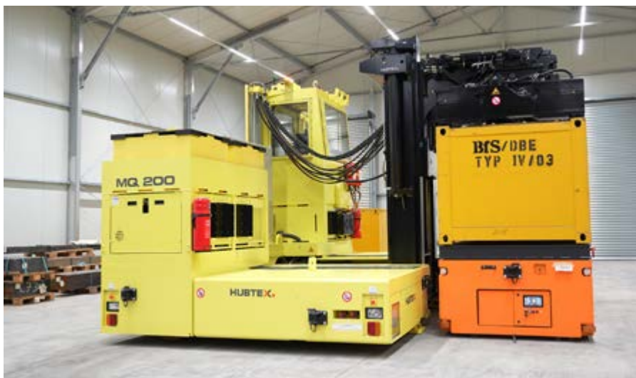
El vehículo lateral SSF completa el sistema coordinado de vehículos y se encarga de las tareas de transporte y transferencia que tiene asignadas. Todos los tipos de vehículos se han adaptado específicamente a las interfaces y los requisitos de seguridad del proceso global.
