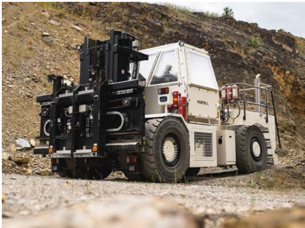
El vehículo apilador SF es uno de los cinco tipos de vehículos especiales que HUBTEX ha desarrollado específicamente para los requisitos del futuro proceso de almacenamiento en la instalación de Konrad.
