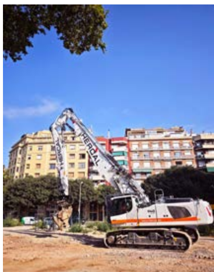
La Liebherr R 940 Demolition de Hercal se destinará a proyectos de demolición selectiva de estructuras industriales y edificios, donde es clave la combinación de precisión y seguridad.
