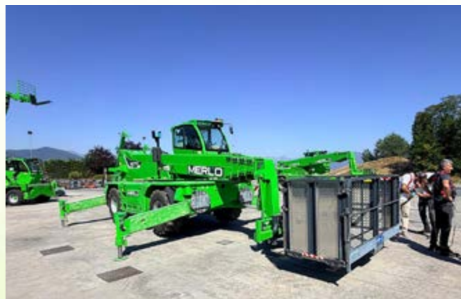
Los ROTO son muy versátiles, ya que se les puede acoplar cesta o gancho
