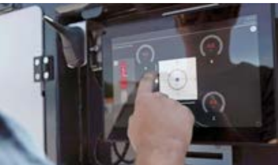
El COG Easy Mode hace visibles las posiciones del centro de gravedad, tanto en el vehículo como, opcionalmente, a través de SCHEUERLE Connect con transmisión en directo del contenido de la pantalla.
