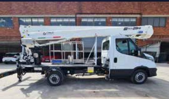
Destacan dos modelos: la nueva plataforma CELA DT28FE, con 28 metros de altura de trabajo sobre camiones de 3.500 kg de PMA, y la DT60, una impresionante plataforma de 60 metros que se puede montar sobre camión de 18 ton y que combina grandes prestaciones con un precio muy competitivo. Ambas refuerzan nuestra apuesta por ofrecer equipos de altas prestaciones en todos los rangos de altura.
