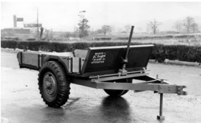
1945 - El primer producto del Sr. JCB: un remolque basculante fabricado con chatarra de guerra
