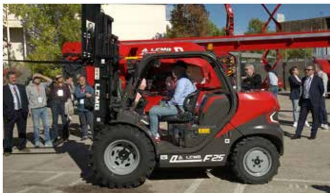
Entre sus ventajas destacan neumáticos de gran tamaño para mejor tracción, dirección hidráulica asistida, sistema de inclinación del mástil (10° hacia adelante / 12° hacia atrás) y una cabina ergonómica con visibilidad total.
