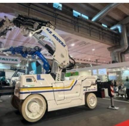
máxima eficiencia y versatilidad a los operadores. Su gran avance tecnológico radica en el sistema de brazos intercambiables, una solución pionera que permite adaptar la máquina a cada necesidad operativa.
