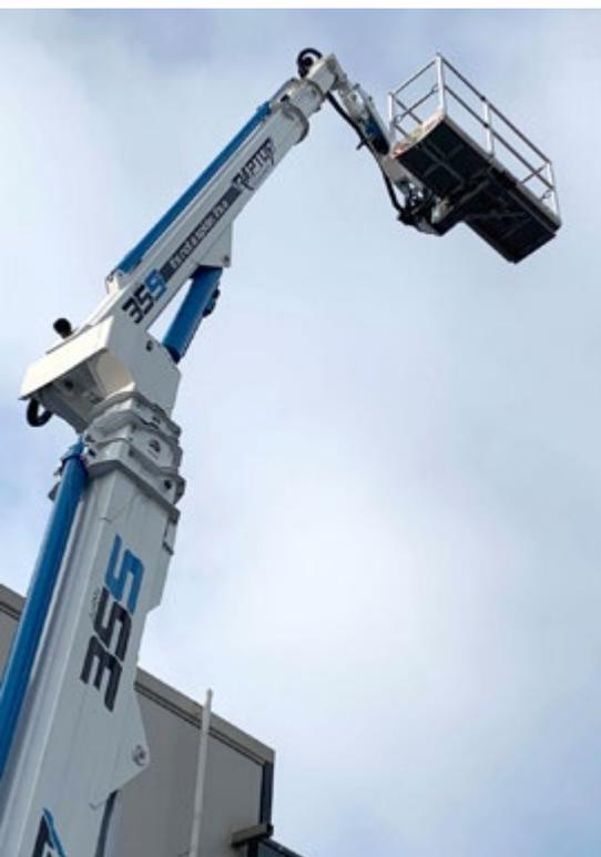
**LA RAPTOR 35S PERMITE OPERAR CON HASTA 300 KG DE CARGA ÚTIL, LO QUE EQUIVALE A DOS OPERADORES MÁS HERRAMIENTAS O MATERIALES**
