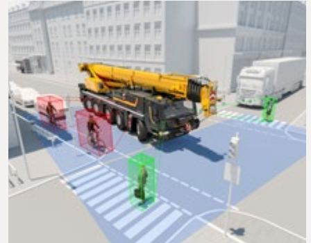
Los sistemas de asistencia al operador escanean el entorno y advierten al operador de la grúa para evitar accidentes.
