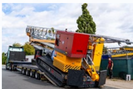
Único: »STEPSTAR« con neumáticos »CARGOPLUS« para una baja altura de conducción de 790 mm y una carga por eje de 10 toneladas.
