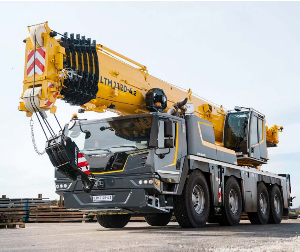
Equipada con el nuevo sistema de control de grúas LICCON3, la LTM 1120-4.2 está preparada de serie para telemetría y gestión de flotas. Con Liebherr Connect, los operadores de grúas podrán acceder y analizar todos los datos relevantes a través del portal de clientes MyLiebherr en el futuro.
