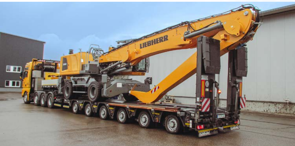
»ARCUS« P con neumáticos »CARGOPLUS«: Altura de carga de solo 735 mm, la más baja del mercado.
