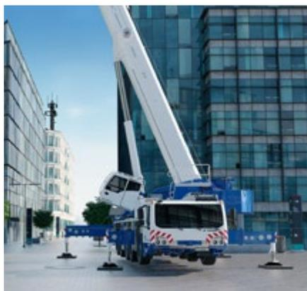
nal para cargas pesadas, con el cual se pueden elevar cargas de hasta 138,7 toneladas con pluma corta y poleas adicionales.
