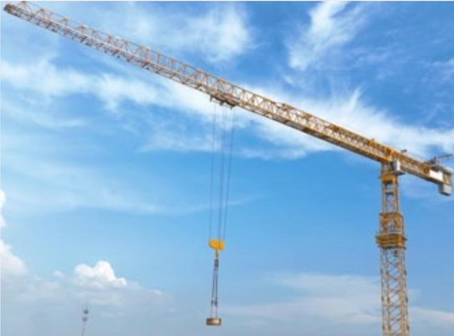
La capacidad máxima está disponible entre los cinco y 26,3 metros con la pluma completa instalada, o 30,5 metros con una pluma de 45 o 50 metros. Alternativamente, puede manejar 72,9 toneladas en la punta de una pluma de 30 metros con cuatro secciones. La grúa está equipada con la cabina V140S Vision de Potain.
