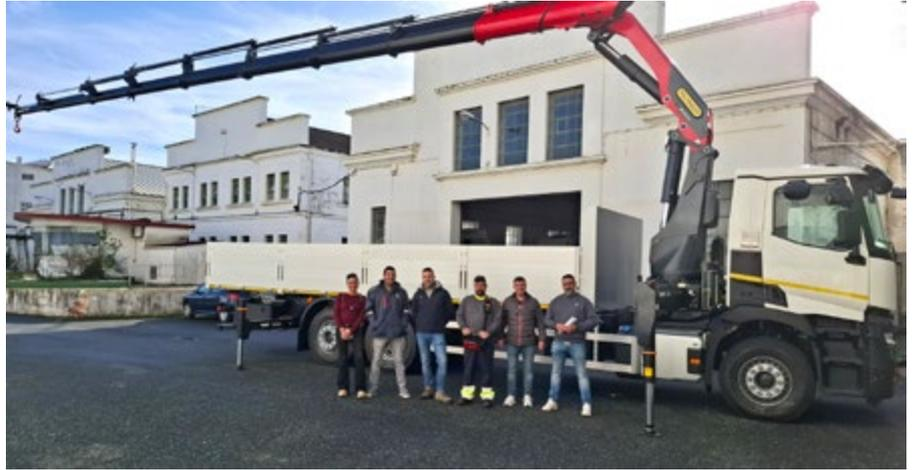
**LA PK 370 TEC ADQUIRIDA Y MONTADA SOBRE RENAULT C R6X2, CUENTA CON 8 PROLONGAS HIDRÁULICAS (G), MOMENTO DE ELEVACIÓN DE 30MT, SISTEMA DE DOBLE BIELA EN BRAZO ARTICULADO INCLINACIÓN 15°**
