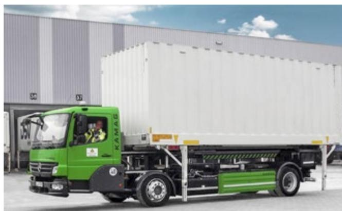
TII KAMAG presentó el primer transportador de carrocería intercambiable totalmente eléctrico en 2016.
