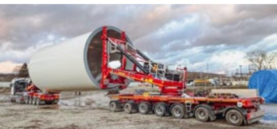
Además, las góndolas y las secciones híbridas de torres de acero pueden cargarse sin adaptadores adicionales. El desplazamiento vertical del adaptador de 1.800 milímetros no solo permite la carga y descarga autónoma de las secciones, sino que también facilita superar obstáculos elevados a lo largo del trayecto, como rotondas, barreras de seguridad o límites de la carretera.
