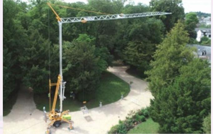
nada a 20 grados por encima de la horizontal. En el radio máximo de 24 metros, alcanza una altura de gancho de 19 metros, con capacidad para levantar hasta 570 kg. Además ofrece una capacidad en la punta de la pluma de 730 kg a un radio de 21 metros y una altura de gancho de 18,8 metros.
