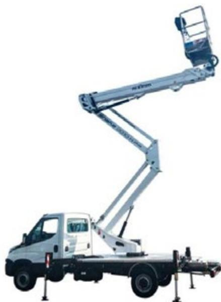
**LA SNAKE 2413 OFRECE UNA ALTURA MÁXIMA DE TRABAJO DE 23,5 METROS Y UN ALCANCE HORIZONTAL DE HASTA 12,6 METROS, PERMITIENDO A LOS OPERADORES ACCEDER A ÁREAS DE DIFÍCIL ALCANCE CON PRECISIÓN Y SEGURIDAD**
