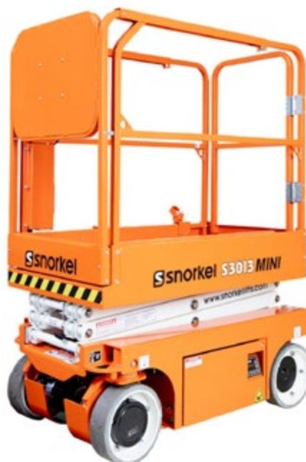
Entre sus innovaciones destacan la extensión de plataforma de 610 mm, el accionamiento eléctrico directo del motor de las ruedas y la dirección eléctrica. La eliminación de mangueras hidráulicas en su diseño reduce los riesgos de fugas y minimiza los costes de mantenimiento. Además, la alimentación con baterías de litio o AGM sin mantenimiento permite una mayor eficiencia energética y una operación más limpia y silenciosa.
