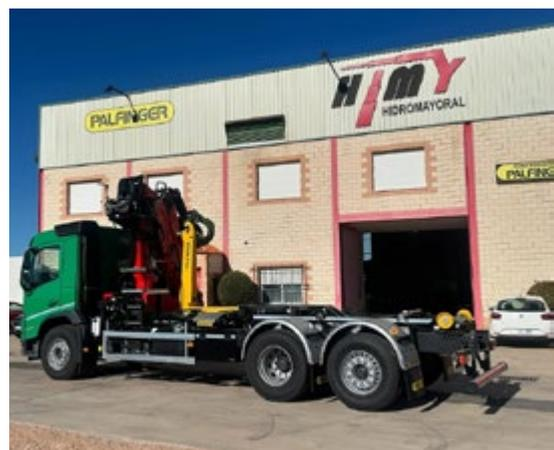
**ENTRE SUS PRINCIPALES CARACTERÍSTICAS, ESTE POLIBRAZO INCORPORA UN SISTEMA DE BLOQUEO MECÁNICO AUTOMÁTICO EN EL BRAZO TELESCÓPICO Y EL CHASIS BASCULANTE, AUMENTANDO LA SEGURIDAD EN LAS MANIOBRAS DE CARGA Y DESCARGA. ADEMÁS, SU TECNOLOGÍA DE DOBLE VELOCIDAD DE TRABAJO CON AMORTIGUACIÓN SOFT STOP OPTIMIZA EL TIEMPO DE OPERACIÓN Y MEJORA LA ESTABILIDAD DEL PROCESO.**
