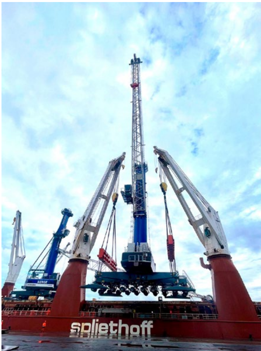
Descarga de la grúa móvil portuaria Liebherr LHM 550 de Bergé en el puerto de Bilbao.
