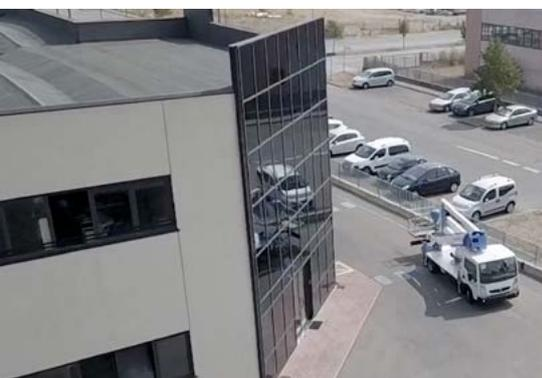
no utilizada en las plataformas sobre camión. Permite no tener el brazo debajo de la cesta y mejorar la aproximación sin peligro de colisión y mayor precisión; a tejados, estructuras o ciertas maniobras en trabajos de poda. Además, facilita y aumenta la seguridad en las posibles salidas del operario en altura para engancharse a la línea de vida obligatoria.
