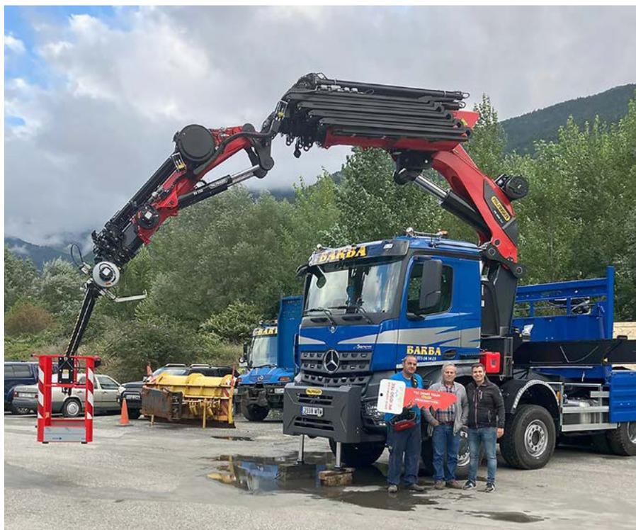
**LA PK 1050 TEC ADQUIRIDA Y MONTADA SOBRE MERCEDES 4151 AK 8X6, CUENTA CON 9 PROLONGAS HIDRÁULICAS (H), FLY - JIB PJ150 E CON 6 PROLONGAS HIDRÁULICAS ADICIONALES, LO QUE LE PERMITE UN ALCANCE HORIZONTAL DE 34.9 M Y HASTA 1020KG DE CARGA**
