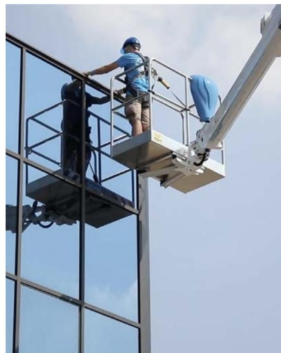
**EL MODELO FORSTE 20D SPEED DESTACA POR UNIR EN UN MISMO EQUIPO CARACTERÍSTICAS TÉCNICAS MUY VALORADAS POR LOS OPERADORES: EL COMPLETO ACABADO SPEED H+H CON ESTABILIZADORES VERTICALES FIJOS (SIN SOBRESALIR DEL CAMIÓN), LA SUJECIÓN FRONTAL DE LA CESTA Y LAS MANIOBRAS VOLUNTARIAS ENTRE OTROS ASPECTOS.**
