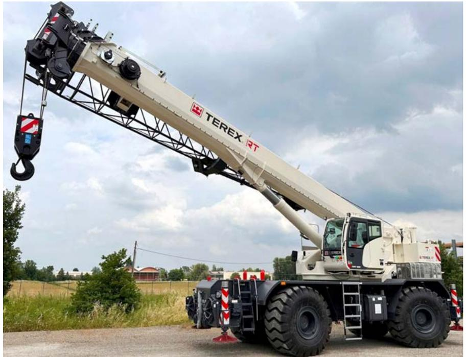
tros y está clasificado a 2.3 metros de radio. Cuenta con un brazo principal de cinco secciones de 42.5 metros y puede manejar ocho toneladas con el brazo completamente extendido a un radio de hasta nueve metros. Se puede agregar una extensión abatible de ocho a 15 metros para llevar la altura máxima de punta a 60 metros, con una inclinación de hasta 40 grados.
