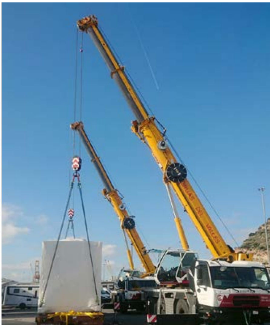
Los modelos GMK3060L-1 de Grúas del Vallés haciendo una elevación en tándem de 35 toneladas en el puerto de Barcelona.
