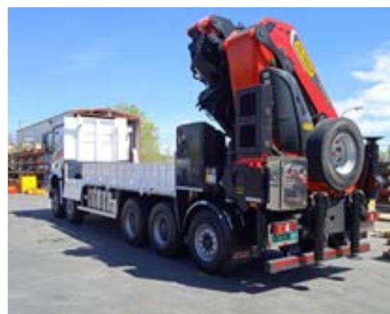
La PK 135.002 TEC 7 con un espectacular montaje trasero hecho sobre MERCEDES 4158 AK, cuenta con 4 prolongas hidráulicas (C), Fly-jib PJ 240 E con 6 prolongas hidráulicas adicionales, lo que le permite un alcance horizontal de 29.7 m y hasta 1600kg de carga. Además, han adquirido tres ganchos diferentes, siendo más espectacular el modelo LH32.0, capaz de soportar hasta 32t.
