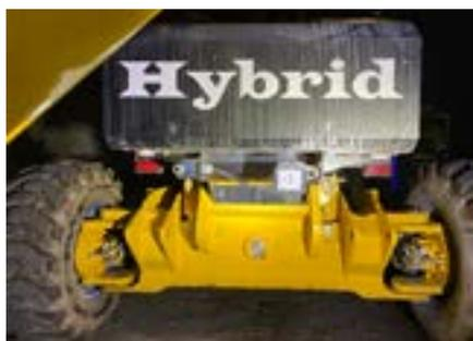
Platform Basket R14 está disponible con una transmisión híbrida, que fue un factor decisivo para Implenía AB. La máquina se puede accionar a través de baterías de iones de litio o a través del motor diesel integrado, que también carga las baterías. Por supuesto, también se puede cargar por cable.
