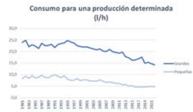
Además de esta mayor eficiencia, también es preciso tener en cuenta que, gracias a las nuevas tecnologías implementadas en las máquinas y a los intervalos de mantenimiento más prolongados, se puede estimar en una máquina fabricada en 2021 una mejora de la productividad de un 10 % con respecto a su modelo equivalente fabricado en 2010. Por lo tanto, el ahorro de combustible real será aún mayor al que podríamos pensar si solo valoramos el consumo medio de combustible.
