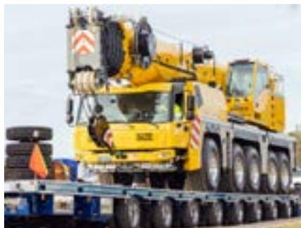
ciones significan que es posible un increíble alcance adicional de 33,8 m. Junto con el sistema de posicionamiento variable de estabilizadores MAXbase, que aumenta las capacidades para aumentar el lugar de trabajo, la grúa puede manipular 9,9 t cuando la disposición estándar de la pluma está a la altura máxima, o 1,3 t cuando el radio de trabajo máximo es de 74 m.
