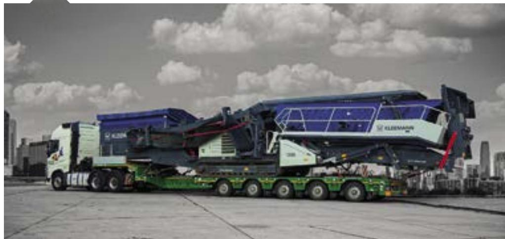
El MANOOVR Multi-PL es la última generación de góndolas de cama baja de Nootboom. Algunas de sus únicas innovaciones rompedoras, incluyen una ultrabaja altura de la cama y la más alta carga por eje, legalmente permitida. La combinación de la altura de la cama de 780 mm y un mínimo de 12 ton por eje hace el MANOOVR excepcional para toda Europa.
