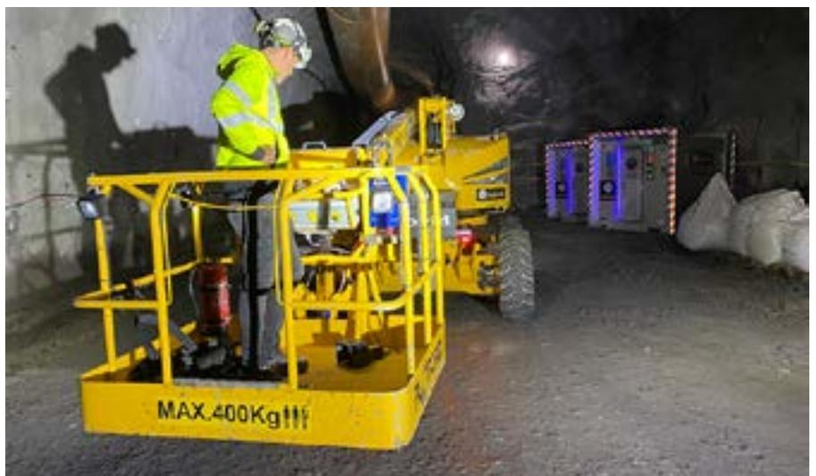
En túneles de servicio que suelen ser bastante irregulares y estrechos, la plataforma Scantruck AB funciona al máximo. Las dimensiones externas compactas, la buena capacidad de elevación y las características todoterreno son tres cartas de triunfo de la Cesta de plataforma R14.
