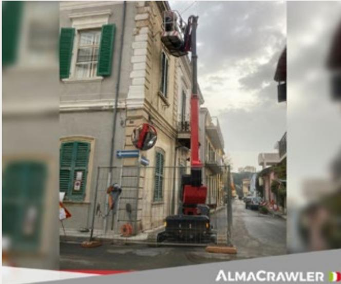
es un equipo que tiene una altura de trabajo de 16 m. con un alcance lateral de 8,50 m, que a su vez permite que la cesta se eleve hasta en una pendiente tanto longitudinal como lateral de 15 grados, pudiendo incluso desplazarse en esta pendiente, con el brazo elevado a 9 m.
