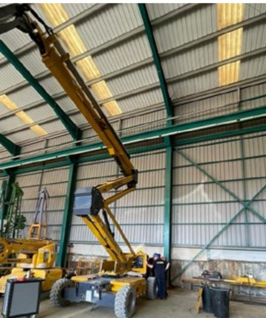
**ESTE MODELO TIENE LA ALTURA MÁXIMA DE PLATAFORMA DE 15,7M, EL ANCHO DE VEHÍCULO DE 1,25M, LA CARGA NOMINAL DE 230 KG Y LA TREPABILIDAD MÁXIMA DE 25%, QUE SE CARACTERIZA POR LA ESTRUCTURA COMPACTA Y LA PROTECCIÓN AVANZADA Y SEGURA.**
