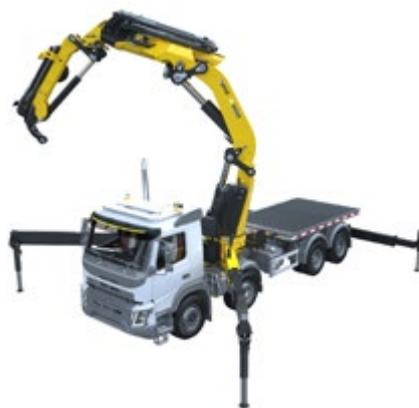
levantar cargas en la parte delantera del camión y hace que los estabilizadores delanteros sean redundantes, lo que ahorra peso y costo de este complemento.
