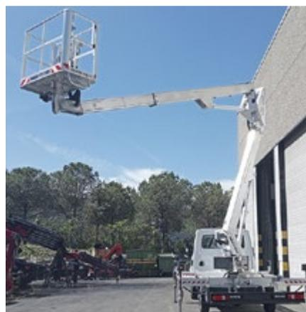
“Muy contento con la evolución de la marca en cuanto a innovación y tecnología, nuestro cliente ha adquirido esta última unidad, una HX200 fabricada en aluminio, característica estrella de la marca, que ofrece 19,9m. de altura de trabajo, 9,6m de alcance lateral y una capacidad en la cesta de 225kg”, comentan desde Transgrúas Cial.
