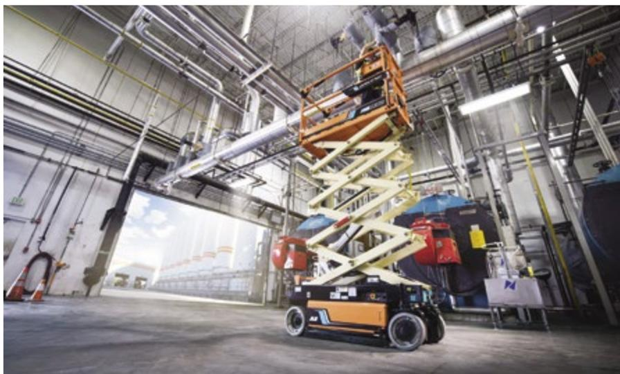
ne de serie con JLG Mobile Control, lo que permite a los usuarios conducir, dirigir y cargar para transportar el elevador de tijera desde un dispositivo móvil iOS o Android.
