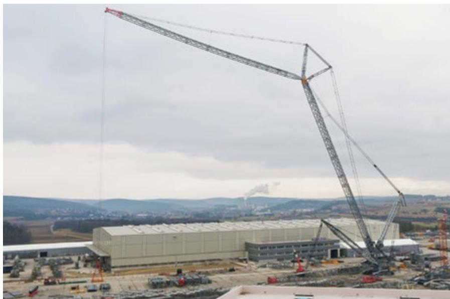
Prueba de la nueva longitud del plumín abatible de 114 metros de la LR 11350 en la fábrica de Liebherr en Ehingen, Alemania.
