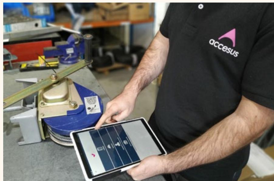
Personal de Accesus llevando a cabo la revisión de un anticaídas retráctil usando el software V.acces desde una Tablet
