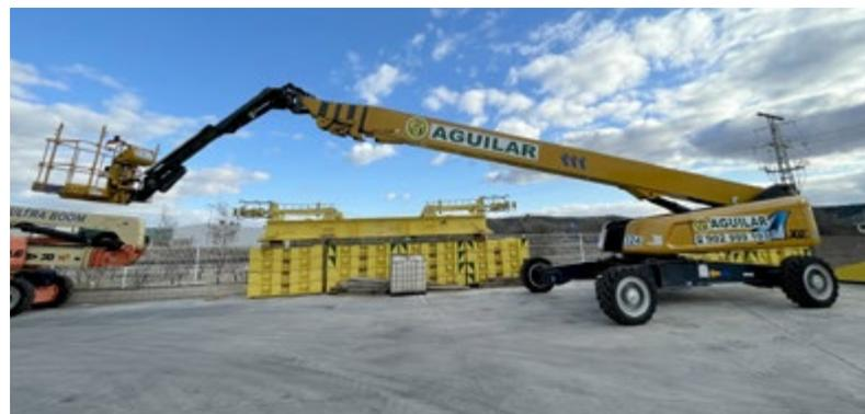
Según XCMG, el rendimiento también fue una parte importante de la ecuación del diseño. Además de proporcionar una capacidad de subida del 45%, tiene un sistema hidráulico sensible a la carga, lo que lo hace energéticamente eficiente. También hay un control de velocidad continuo para garantizar movimientos de trabajo suaves.
