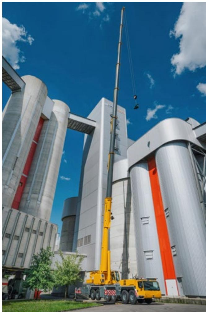
El elemento más destacado de la nueva LTM 1300-6.3 es la pluma telescópica de 90 metros de longitud
