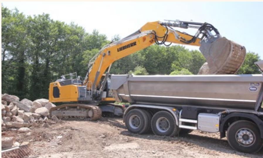
Gracias a su protección de oscilación inferior, la R 934 G8 permite una carga segura de camiones.
