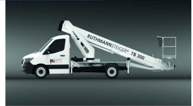
Se lanza una plataforma sobre camión rediseñada y sofisticada, que con su sensacional altura de trabajo de 30 m y 17.1 m de alcance lateral ofrece datos de rendimiento sin precedentes en un chasis de 3.5 t. Con estas novedades, se puede llegar a áreas de trabajo que antes solo era posible abortar con plataformas sobre camión de 7,5 t.
