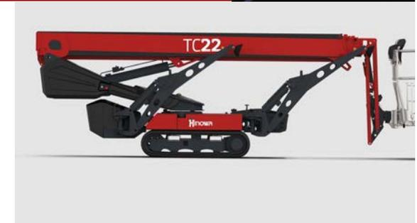
tracción sobre orugas eléctrico (en la versión "full electric"), tiene incorporadas las funciones "Go home" y "Go back" a través de las cuales el sistema memoriza la posición de cierre y la de trabajo y el operario puede bajar a tierra y volver al punto exacto en el que interrumpió su labor con solo una pulsación del botón. Además de la comodidad y el evidente ahorro de tiempo, este sistema minimiza los riesgos al reducir el número de maniobras.
