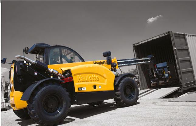
El HTL 3207 proporciona una capacidad de elevación máxima de 3,2 toneladas y está diseñado para elevar cualquier tipo de carga hasta una altura de 6,85 m. Con un radio de giro corto y una longitud de 4,67 m, esta nueva máquina puede acceder fácilmente a espacios estrechos.
