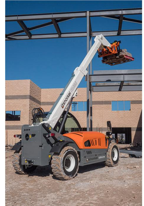
Como el único manipulador telescópico totalmente eléctrico del mercado, el SR626E lidera la industria con tecnología de emisiones cero, al tiempo que sigue cumpliendo y superando el rendimiento de los manipuladores telescópicos compactos para terrenos difíciles diésel. Viene equipado con un carro fijo de 1,2 m x horquillas para palés de 1,2 m como estándar.
