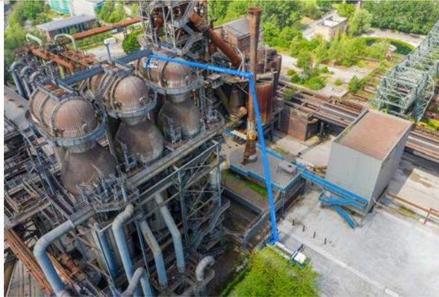
70 m está diseñada con una pluma superior triple extra-largo de 24,6 m. Tiene una capacidad max. en cesta de 600 kg y llega a unos 41,00 m de alcance lateral.
