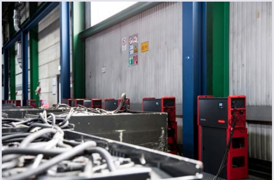
Los cargadores Selectiva vienen equipados de fábrica con una carga en flotación, que permite que las baterías conectadas se carguen suavemente cuando no se estén utilizando y se puedan usar inmediatamente aunque hayan estado inactivas durante mucho tiempo
