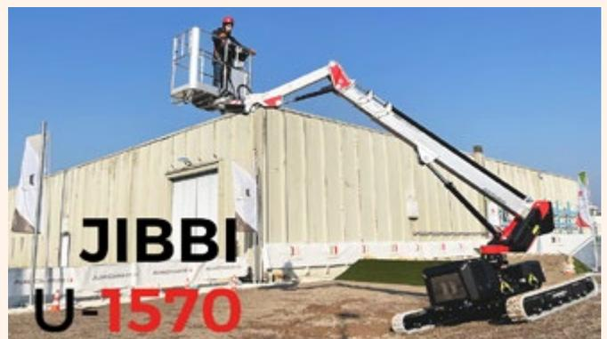
reas tradicionales no pueden resolver. La nueva JIBBI U-1570 es una plataforma autonivelante con brazo telescópico, adecuada para muchas aplicaciones. Su tamaño asegura facilidad de uso y movimiento, gracias también a la cesta (1,4 m de ancho) diseñada para permanecer en el mismo ancho de dimensionamiento de la máquina
