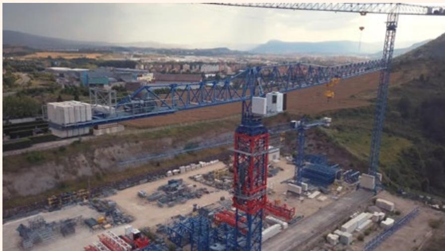
La nuevas grúas torre 21LC600 y 21LC650 de COMANSA tiene dos versiones de carga máxima: 20 y 25 toneladas.
