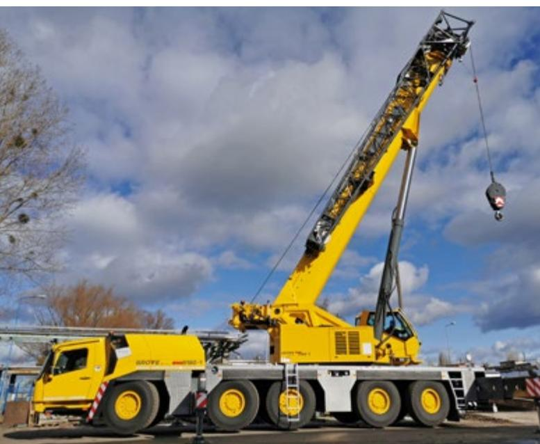
La GMK5180-1 tiene una capacidad de carga nominal de 180 t, 64 m de pluma y una altura de punta total de 101 m.
