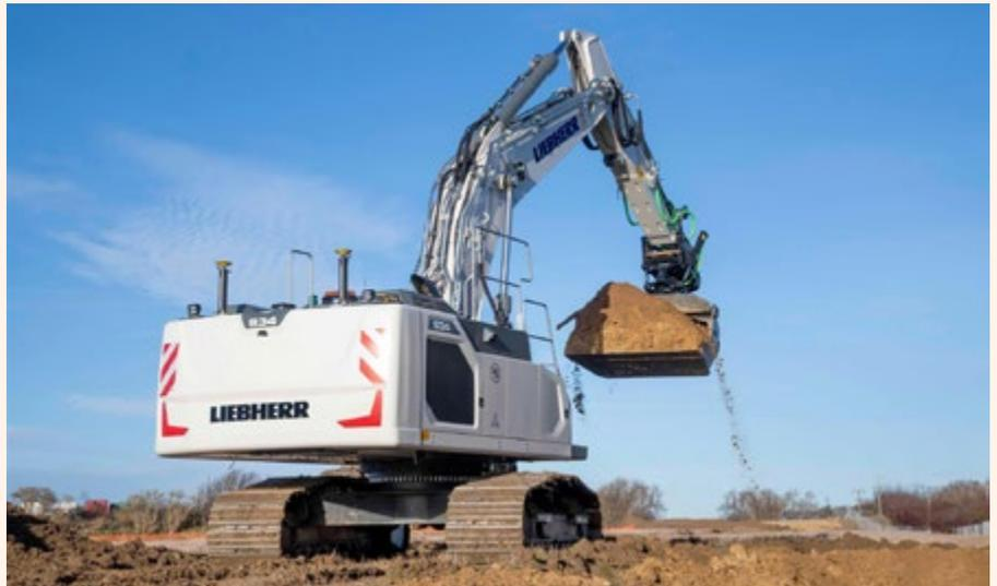
Excavadora de cadenas Liebherr R934 G8, la primera excavadora hidráulica equipada de fábrica con un sistema de control Leica Geosystems, ha sido suministrada al cliente Brad-Pave en Gran Bretaña.
