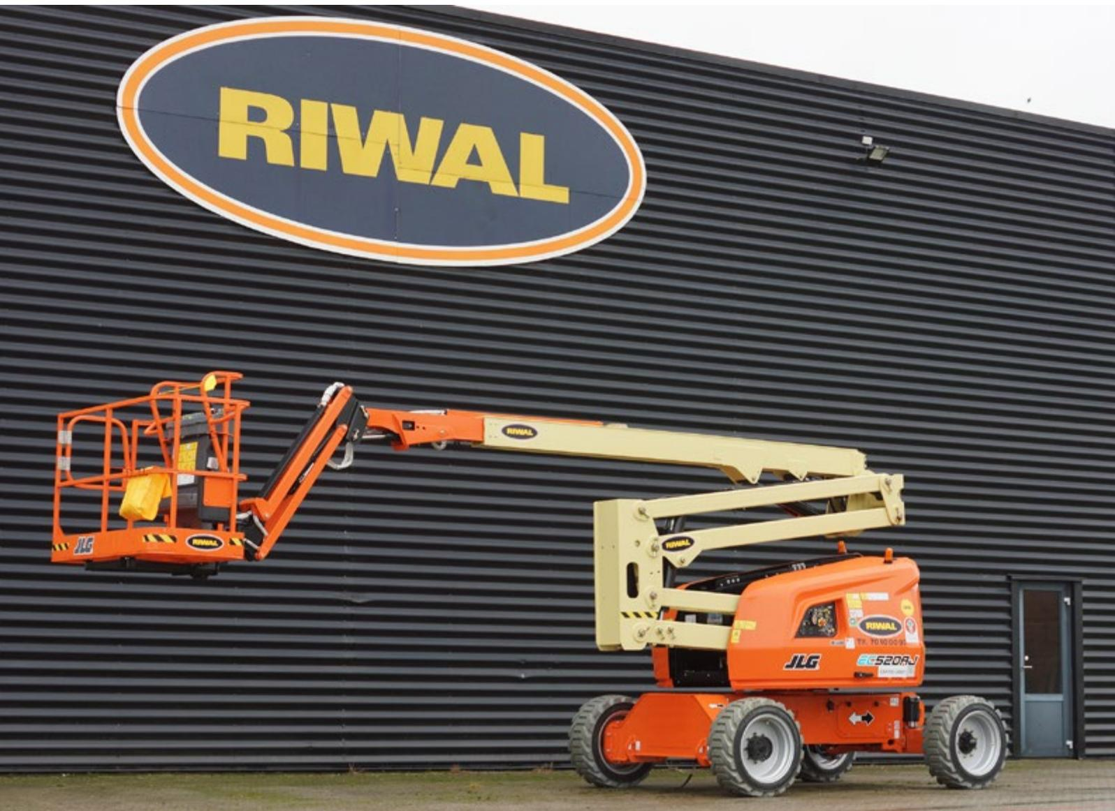
Las nuevas plataformas articuladas eléctricas son el modelo JLG EC450AJ, con una altura de trabajo de 15,77 metros, y el JLG EC520AJ con una altura de trabajo de 18 metros.
