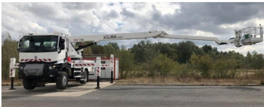
350 TBE: una altura de trabajo de 35 m y un desplazamiento de 25,60 m
