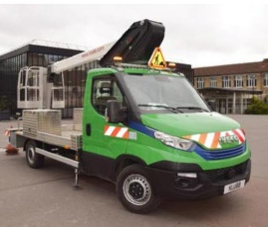
**K32 sobre chasis Iveco Gas, Altura de trabajo de 12,50 m y Offset de 7,30 m**
