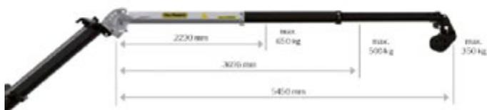
El MFA – JIB o prolonga manual, es un accesorio removible de elevación de la carga que cumple con la normativa EN13155. Éste se monta en la grúa articulada mediante el adaptador multifuncional y se integra de forma fácil con el sistema electrónico de estabilidad de la grúa “TOOL”.
