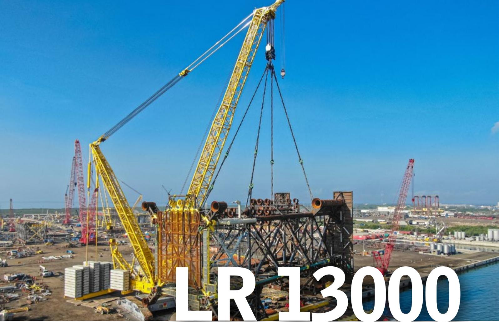
La LR13000 tiene una configuración de pluma principal SL de 84 metros, derrick y un total de 1.400 toneladas de contrapesos en la bandeja.
