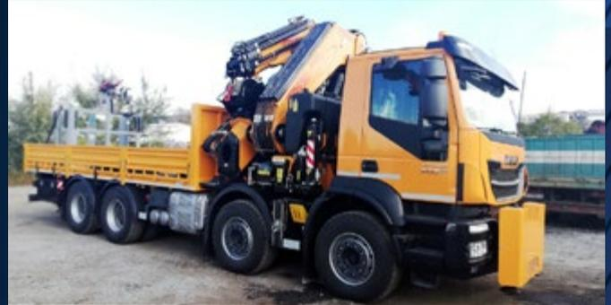
Por otra parte se ha presentado novedades tecnológicas como el FX-Link, la nueva tecnología "Drive by Fassi" desarrollada en colaboración entre Fassi y Volvo en que el operador puede "conducir" el camión del radiomando Fassi V7 desde fuera de la cabina.
